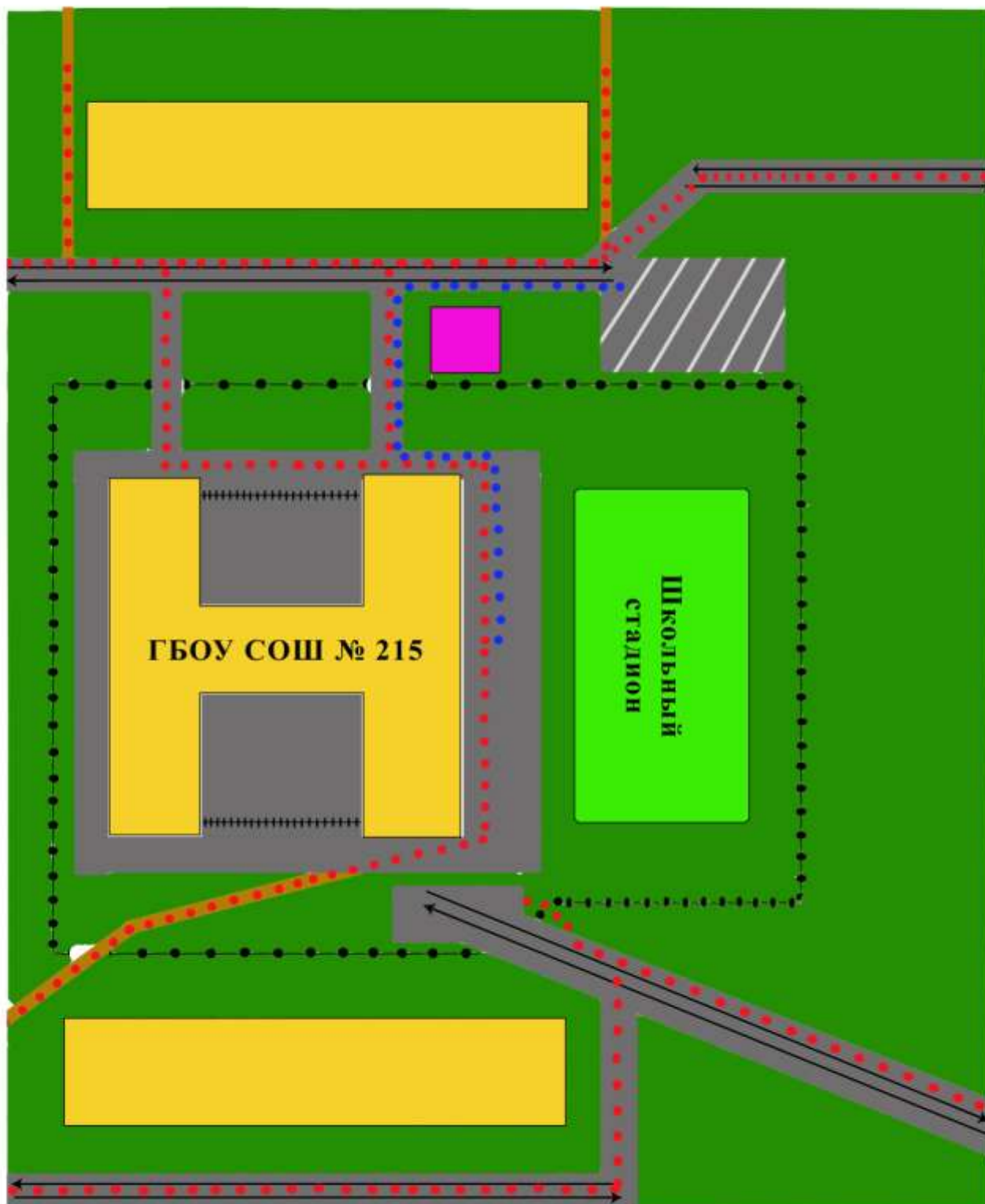
Схема организации дорожного движения в непосредственной близости от образовательной организации с размещением соответствующих технических средств, маршруты движения детей и расположение парковочных мест
